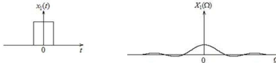
(β) Σήμα x_1(t) = x(at) με \alpha > 1 και το φάσμα του X_1(\omega) .
