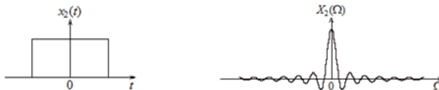
(γ) Σήμα x_2(t) = x(at) με 0 < \alpha < 1 και το φάσμα του X_2(\omega) .
